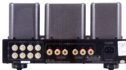
入力端子はRCA3系統。スピーカー出力端子は、使用スピーカーに合わせ、4Ωか8Ωを選択する
